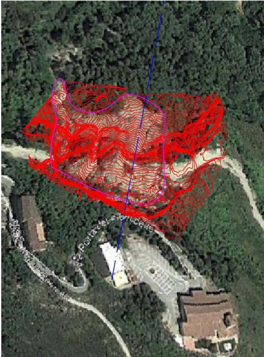
Figura 3 - Immagine area della frana del 06/03/2012 con delimitazione dell'area di frana (in magenta), rappresentazione delle curve di livello post frana (in rosso) e indicazione della sezione considerata A-A (in blu) per la valutazione degli spostamenti [2].
