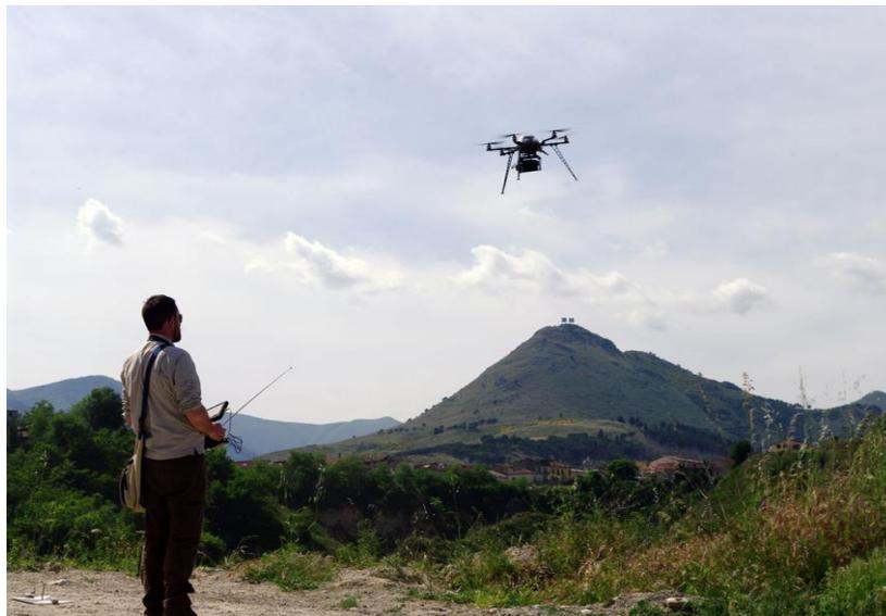
Figura 2 – Drone impiegato per la rilevazione aerea della frana [3].
